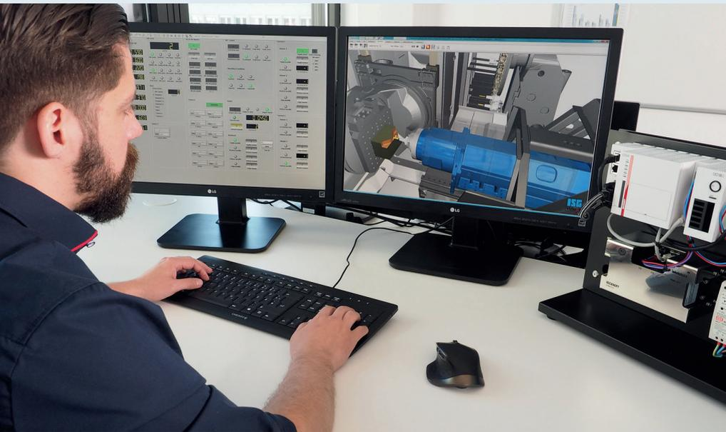
1 Der Systemtest an einem digitalen Zwilling gestattet exakte Aussagen zur Leistung unter Berücksichtigung aller Komponenten und Baugruppen inklusive der Störsituationen (© ISG)
